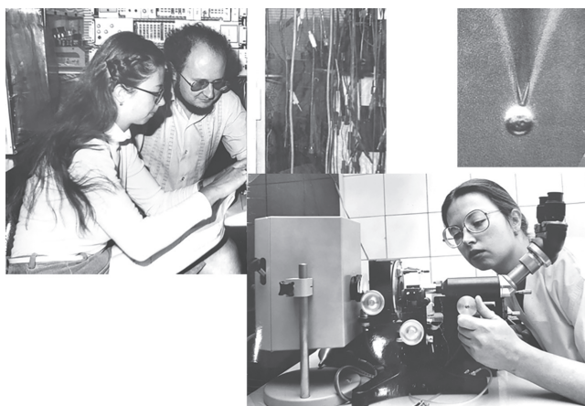
Vľavo: A. Zahradníková a J. Osipčuk programujú PMD 85 pre riadenie patch-clamp experimentu. Vpravo hore: Mikroelektroda s prisatou červenou krvinkou experimentátora. Vpravo dole: Príprava mikroelektrody pre patch-clamp experiment.
