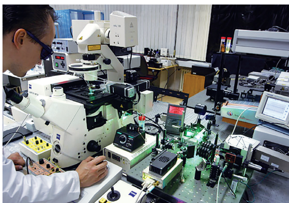
Laboratórium Biofotoniky MLC. Obrázok spektrálne a časovo rozlíšeného konfokálneho mikroskopu
